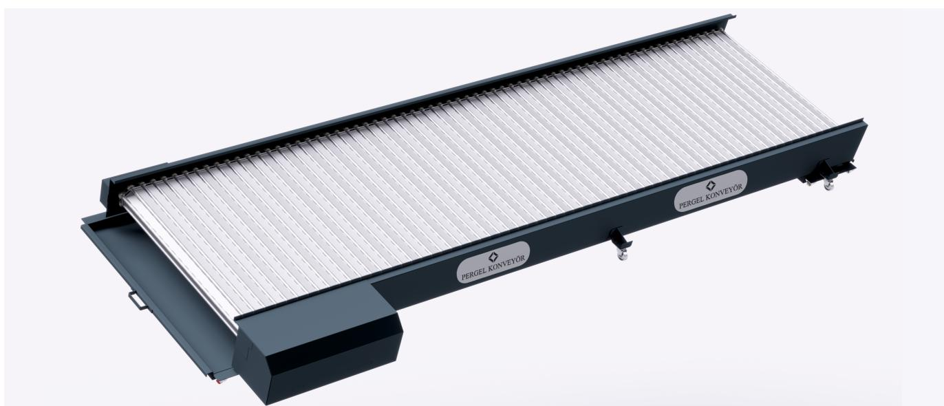
CNC lazer kesim tezgahlarında kesim esnasında oluşan parça, çapak ve kesim artıklarının, tezgahın dışına taşınması için kullanılan konveyörlerdir.
