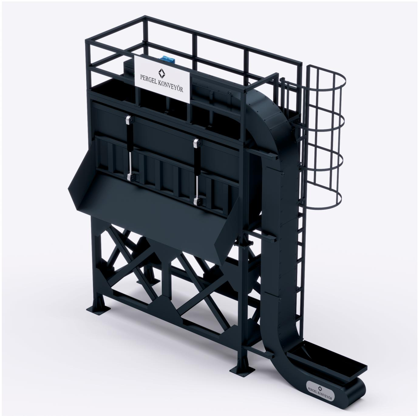
Hat konveyörlerinden çıkan talaşların yüksek kapasitede depolanması ve istenildiğinde kamyon vb. araçlara nakledilmesini sağlayan yapılardır.
